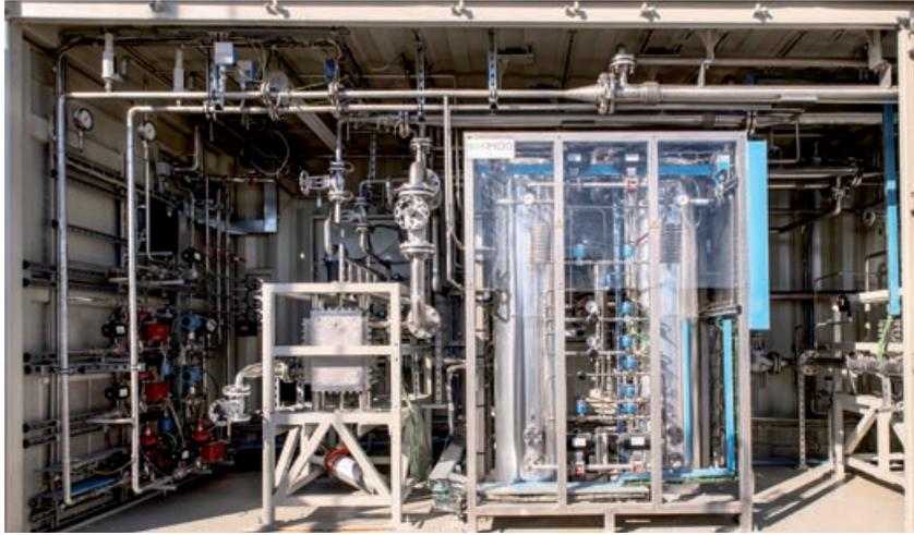
➤ Conçu par Khimod, le méthaneur permet de transformer l'hydrogène vert et du CO<sub>2</sub> recyclé en du méthane de synthèse.
