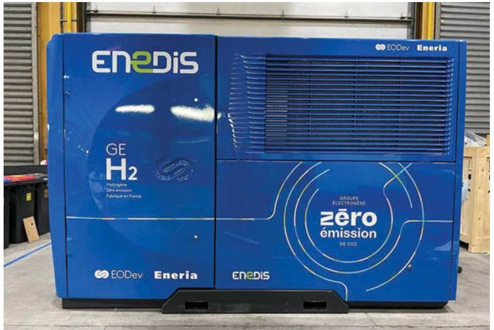
▸ Un prototype de groupe électrogène zéro émission, parmi d'autres développés par Enedis et ses autres partenaires industriels.
