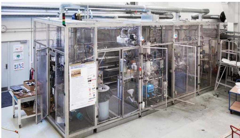
➤ Installée à l'Université d'Aarhus (Danemark), l'usine pilote du projet HyFlexFuel transforme en biocarburants différents types d'intrants comme des boues d'épuration, des déchets alimentaires, du fumier, de la paille de blé, des tiges de maïs, de la sciure de pin, du miscanthus et des microalgues.
