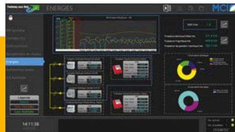
➤ Un système de supervision et de pilotage à distance permet d'optimiser les réglages de la production de froid.
