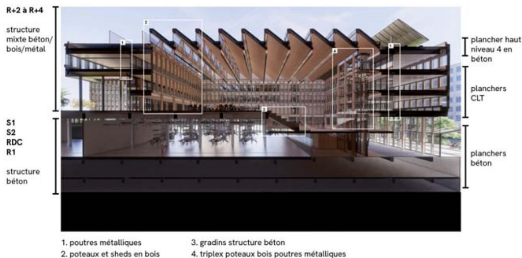
« Coupe transversale du centre de recherche In'cube »
