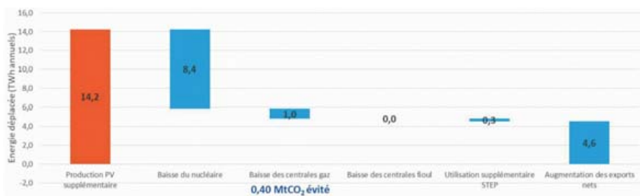
➤ Effet de l'augmentation des capacités solaires de 41,5 à 54 GW en 2030 sur les productions en France.
