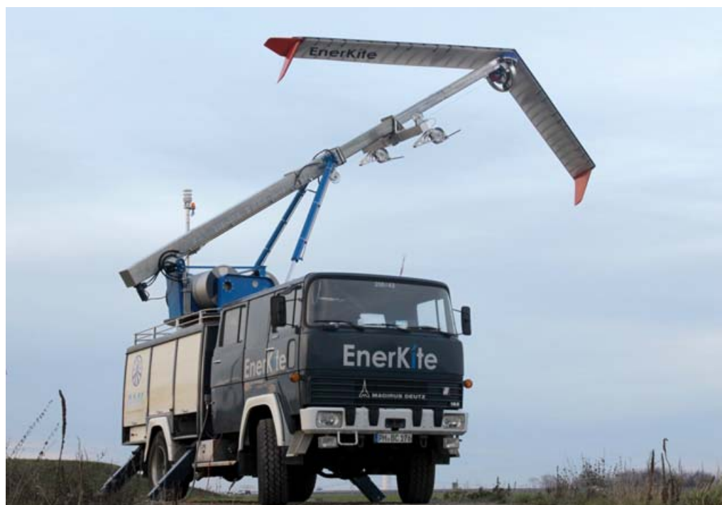
► Enerkite développe une aile en forme de V dans une optique de poids et de coût minimisés.
